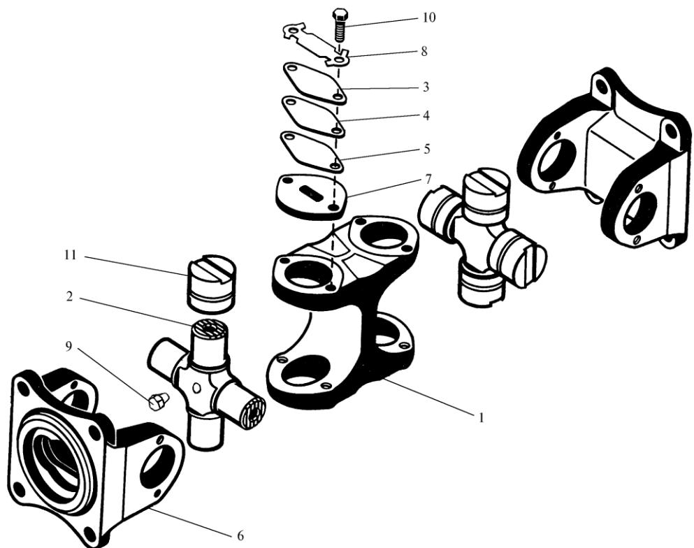
Рис. 34а. Вал карданный передний (К-703М-12)
