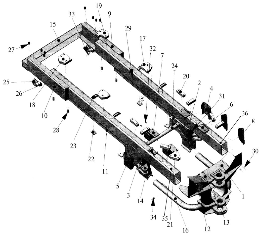
Рис. 39а. Полурама подмоторная для двигателя ЯМЗ-238НД4
