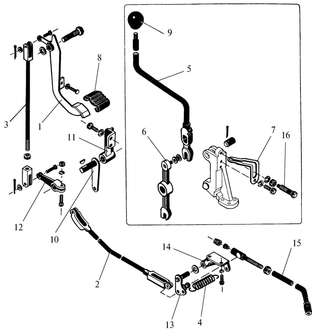
Рис. 18. Управление переключением передач
