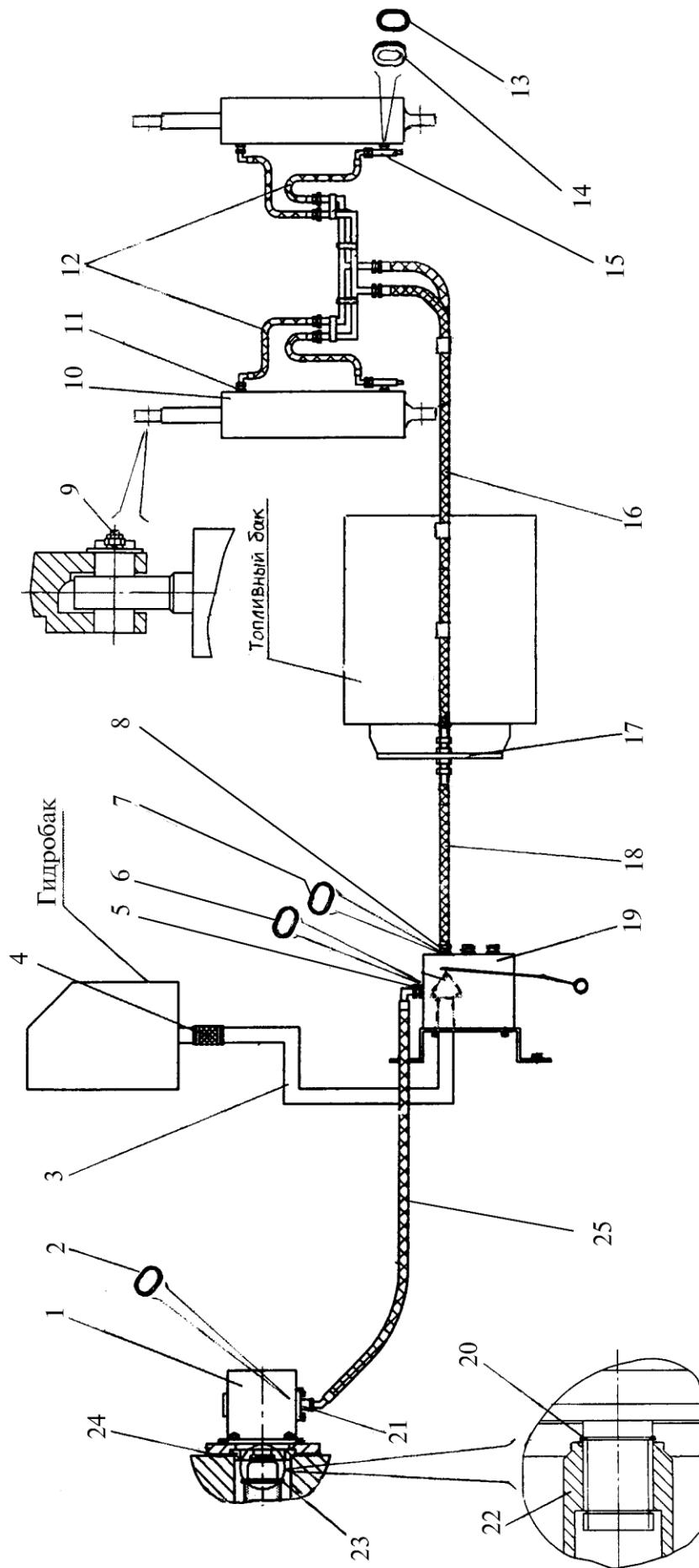
Рис. 75. Гидросистема управления рабочим оборудованием
