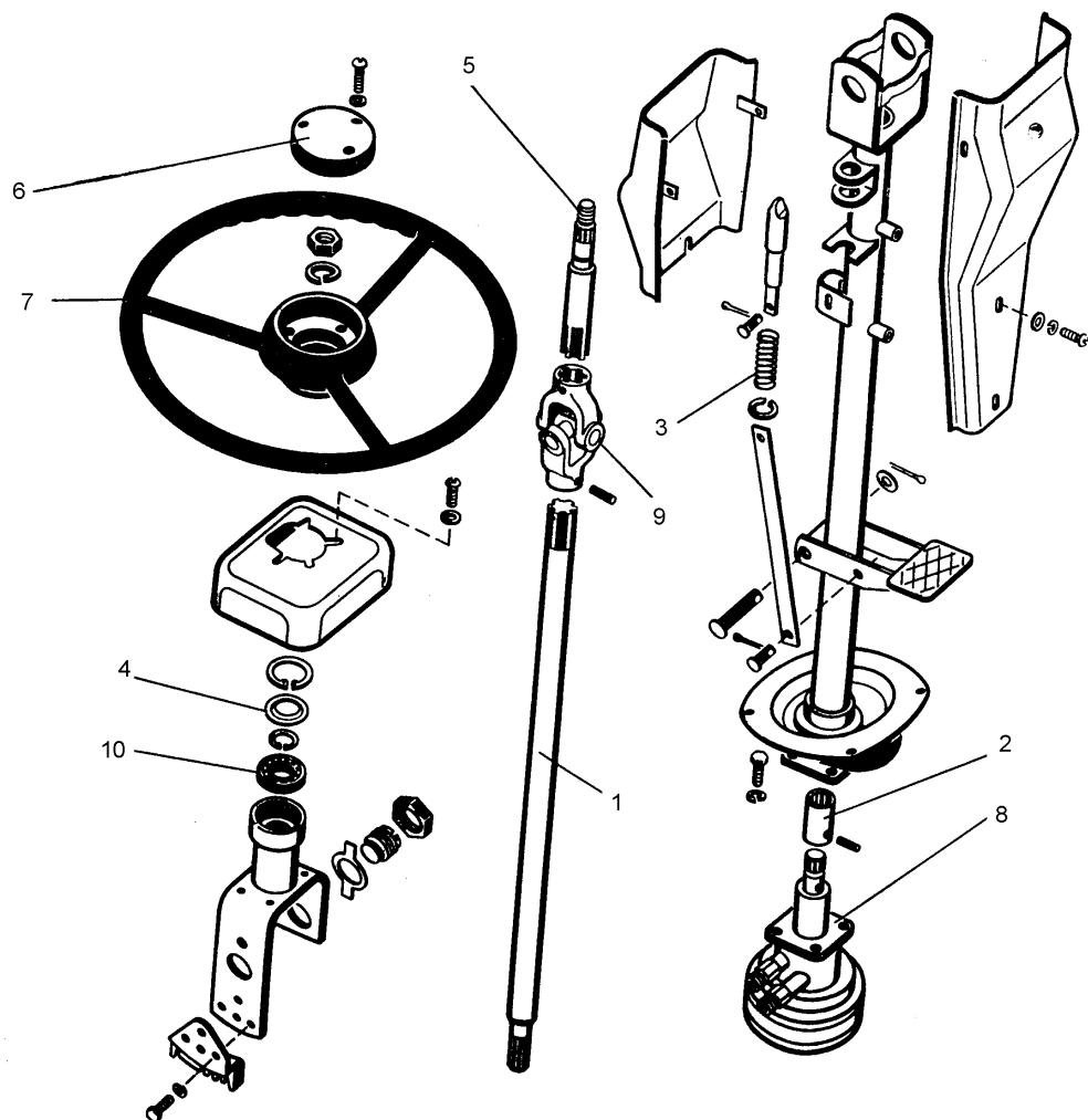
Рис. 46. Рулевая колонка (ГА-35, ГА-36)
