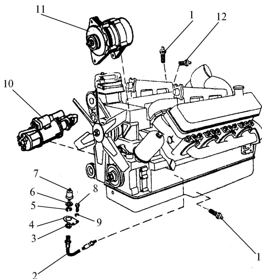
Рис. 71. Электрооборудование двигателя (К-703МА-12)
