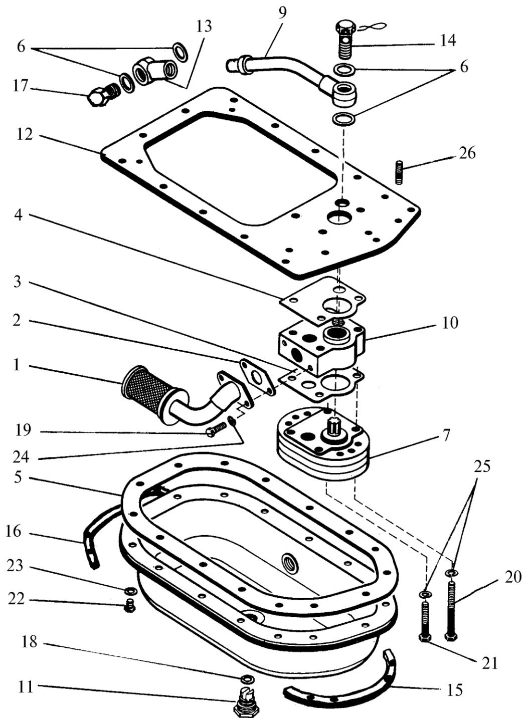
Рис. 31. Насос коробки передач
