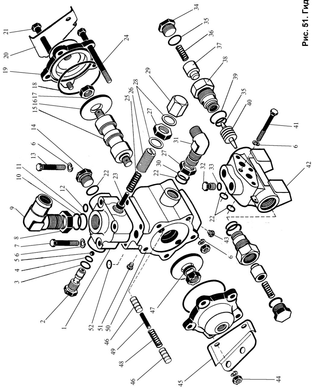
Рис. 51. Гидрораспределитель
