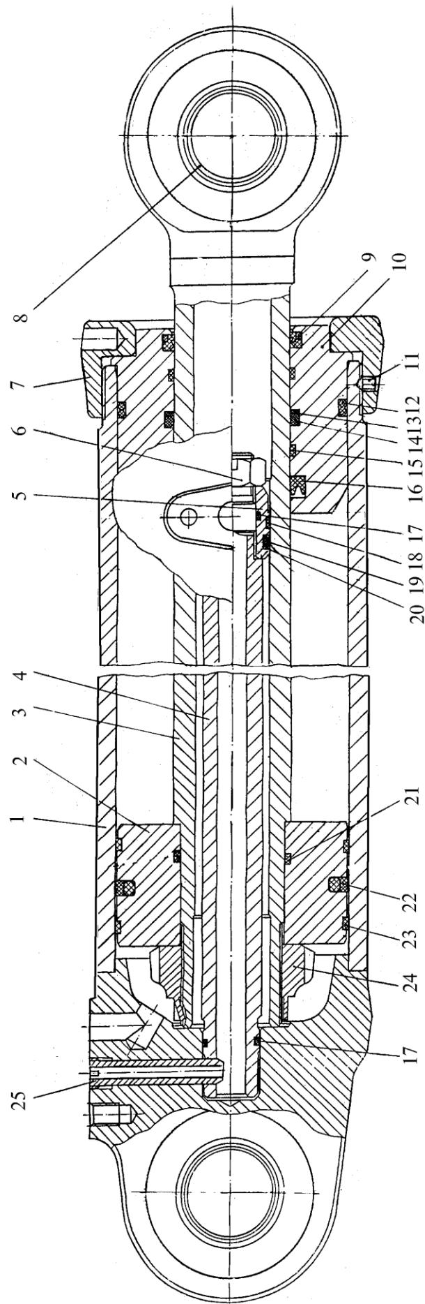
Рис. 49. Гидроцилиндр поворота (ГА-35, ГА-36)
