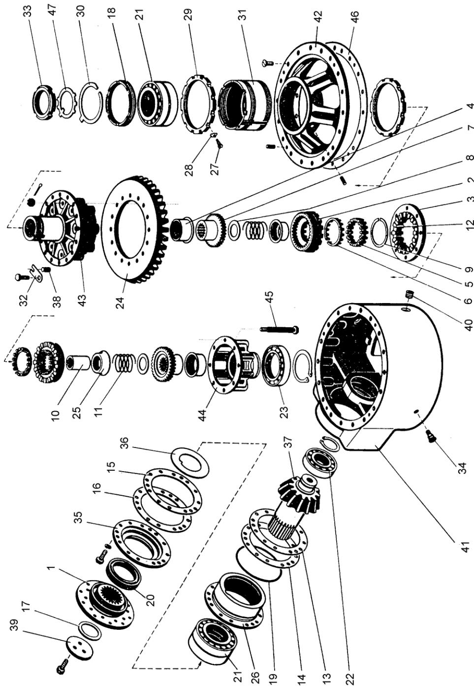
Рис. 43. Главная передача с дифференциалом
