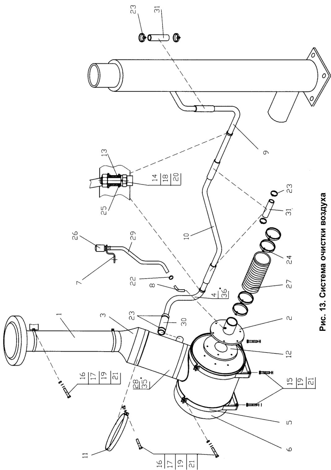
Рис. 13. Система очистки воздуха
