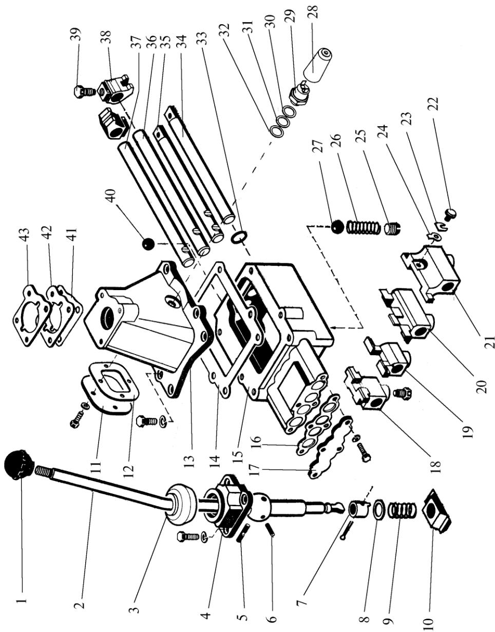
Рис. 19. Привод управления коробки передач
