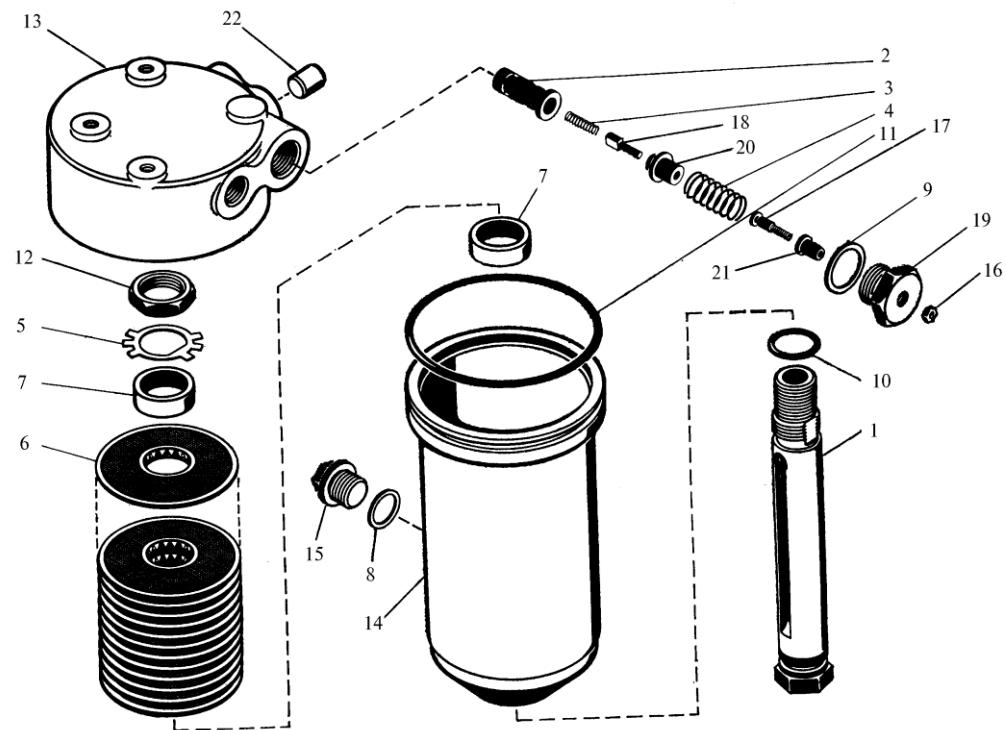
Рис. 32. Фильтр коробки передач
