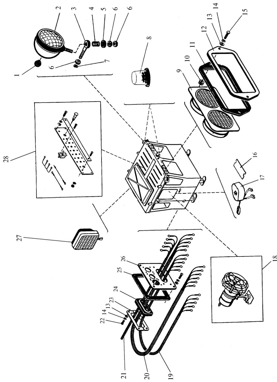
Рис. 73. Электрооборудование кабины (К-703МА-12)
