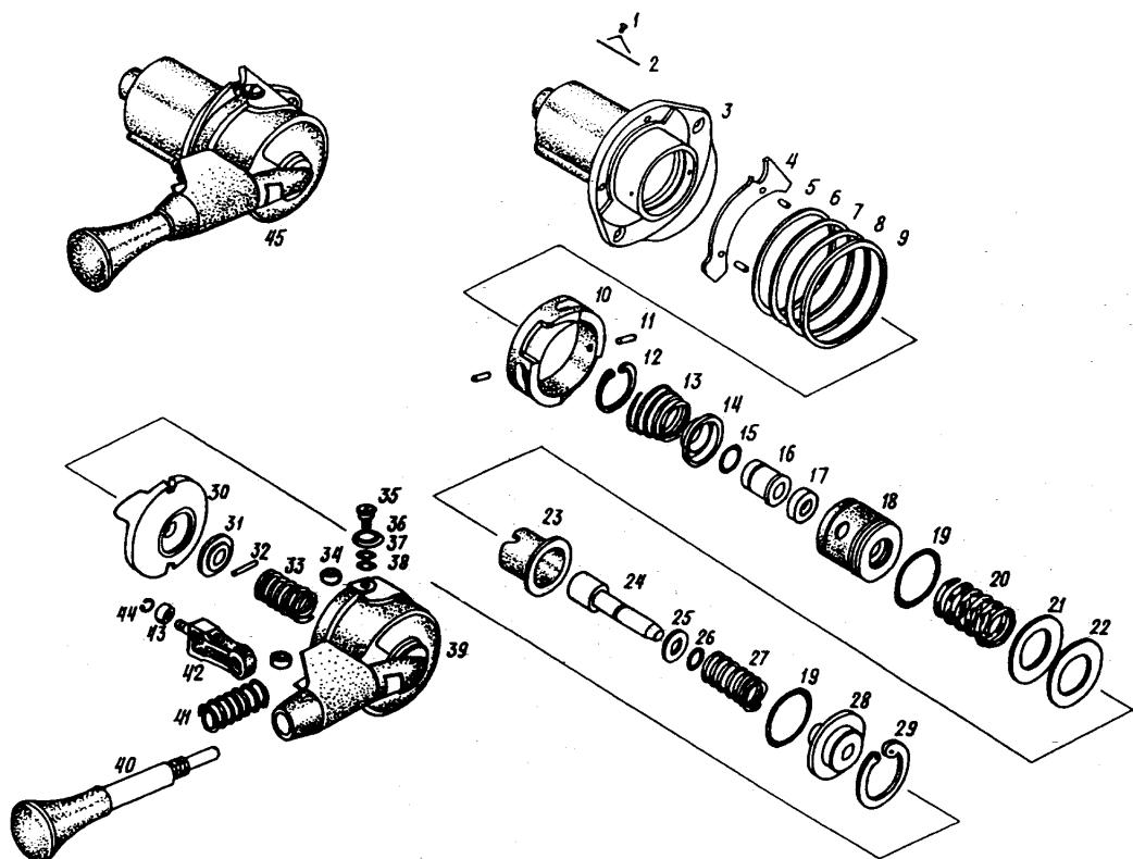
Рис. 55. Кран тормозной обратного действия с ручным управлением
