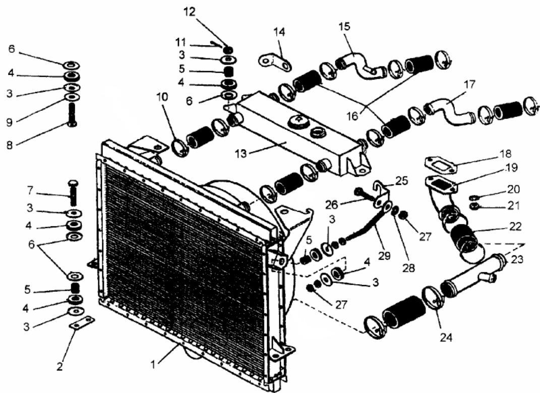
Рис. 8. Система охлаждения двигателя (К-703МА-12)
