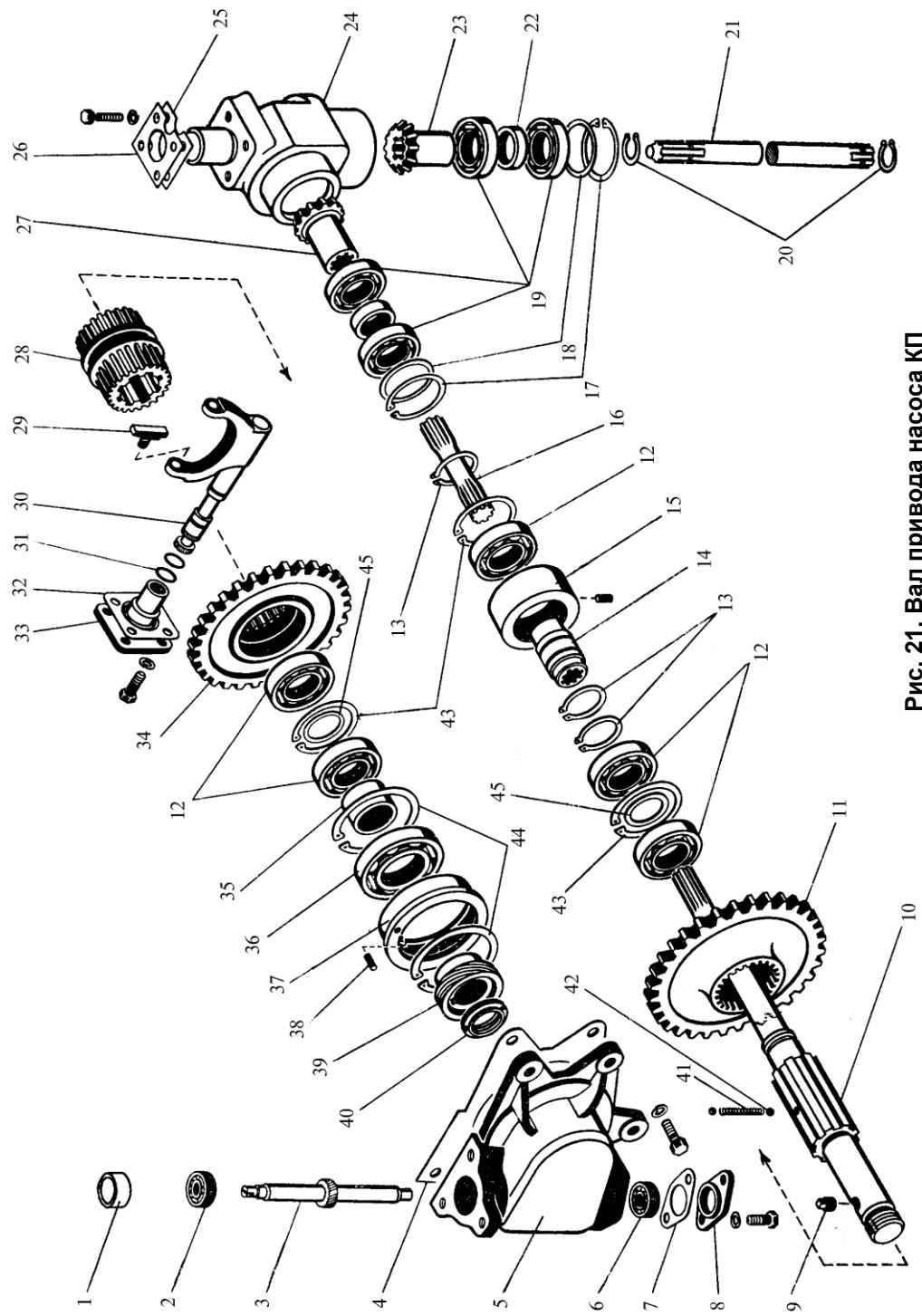
Рис. 21. Вал привода насоса КП
