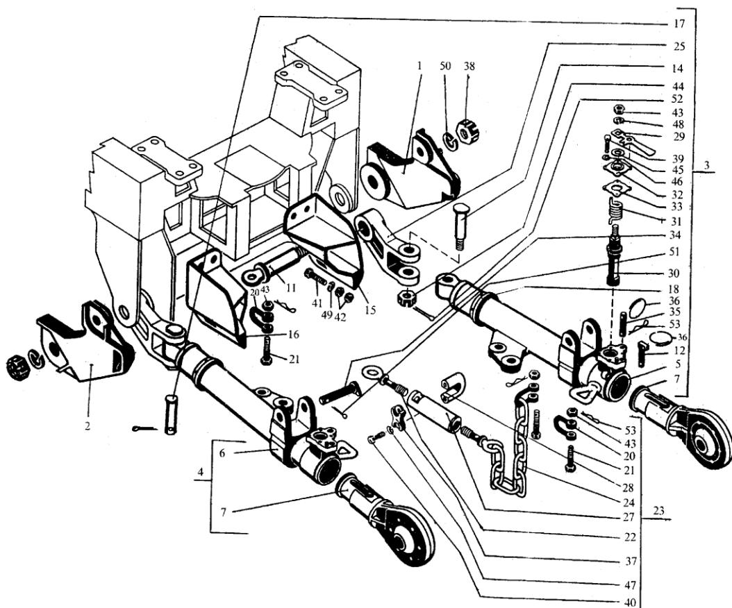
Рис. 59. Механизм навески (нижняя часть)
