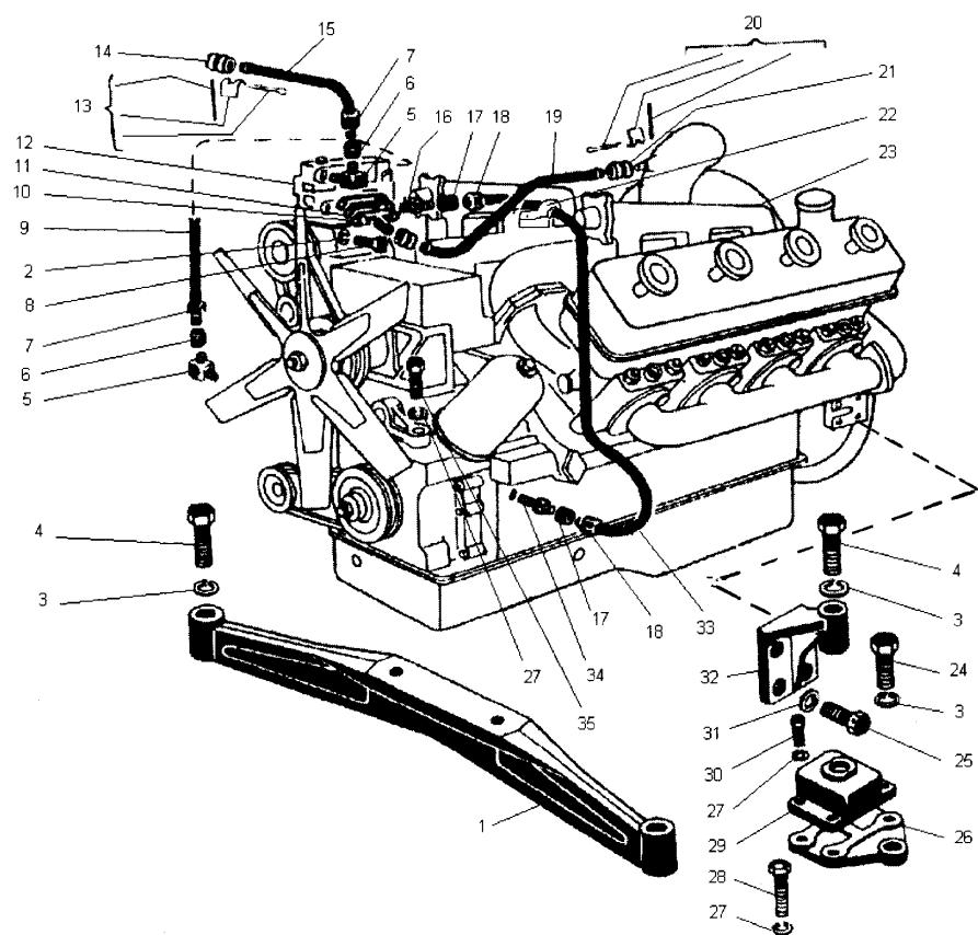
**Рис. 2. Установка двигателя ЯМЗ-238НД4 (К-703МА-12)**
