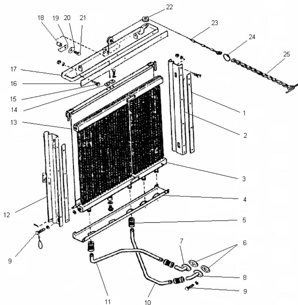
Рис. 11. Система охлаждения масла двигателя (К-703МА-12)
