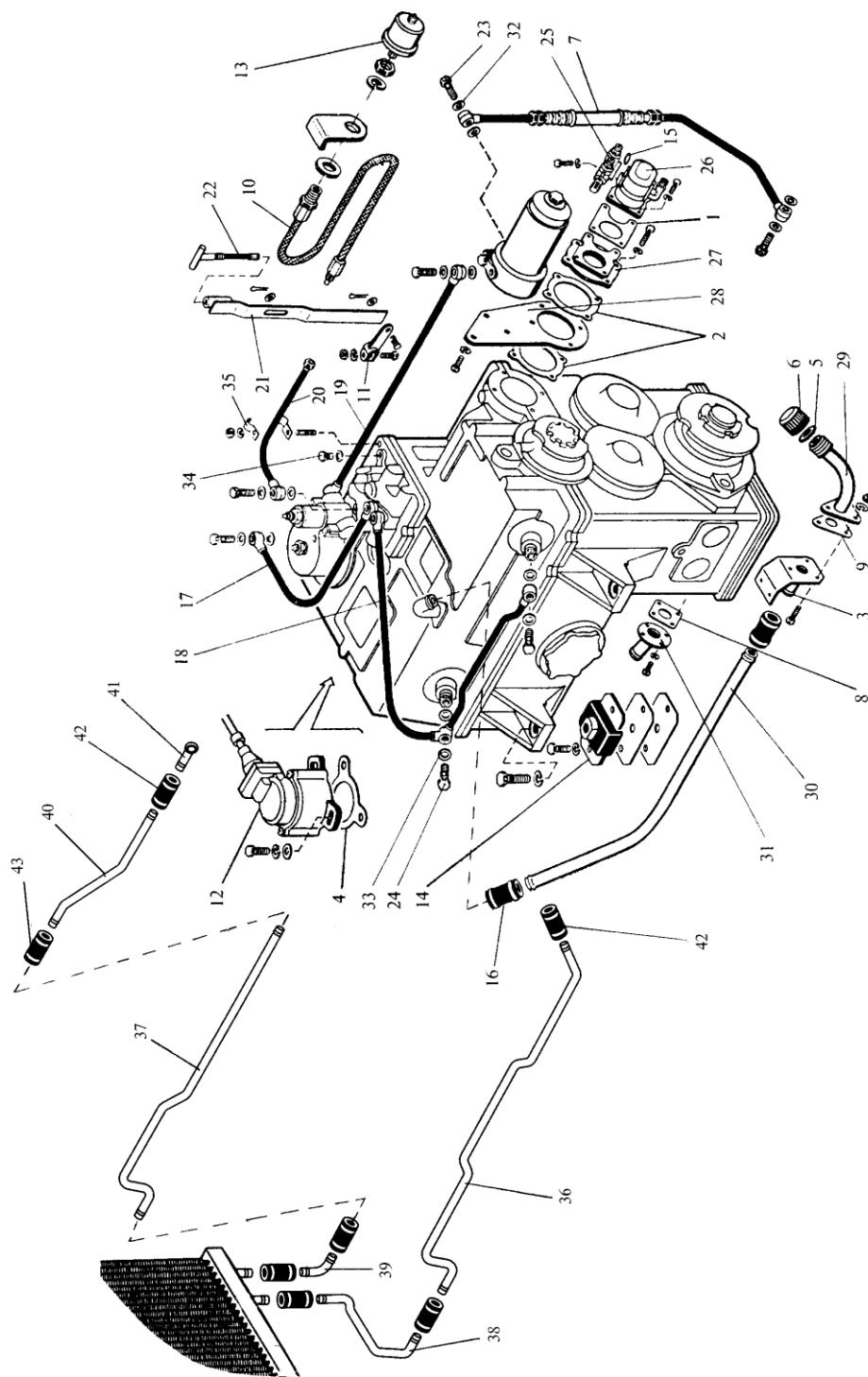
Рис. 17. Установка коробки передач (К-703МА-12)
