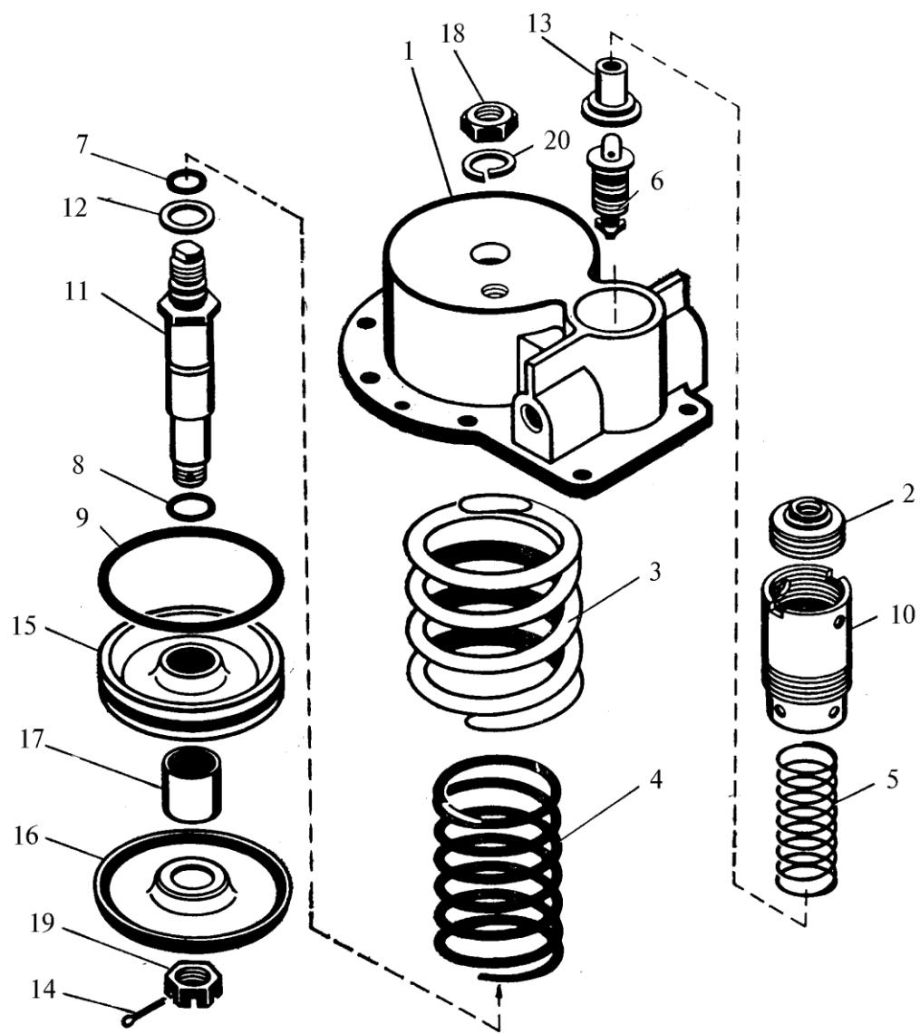
Рис. 30а. Гидроаккумулятор
