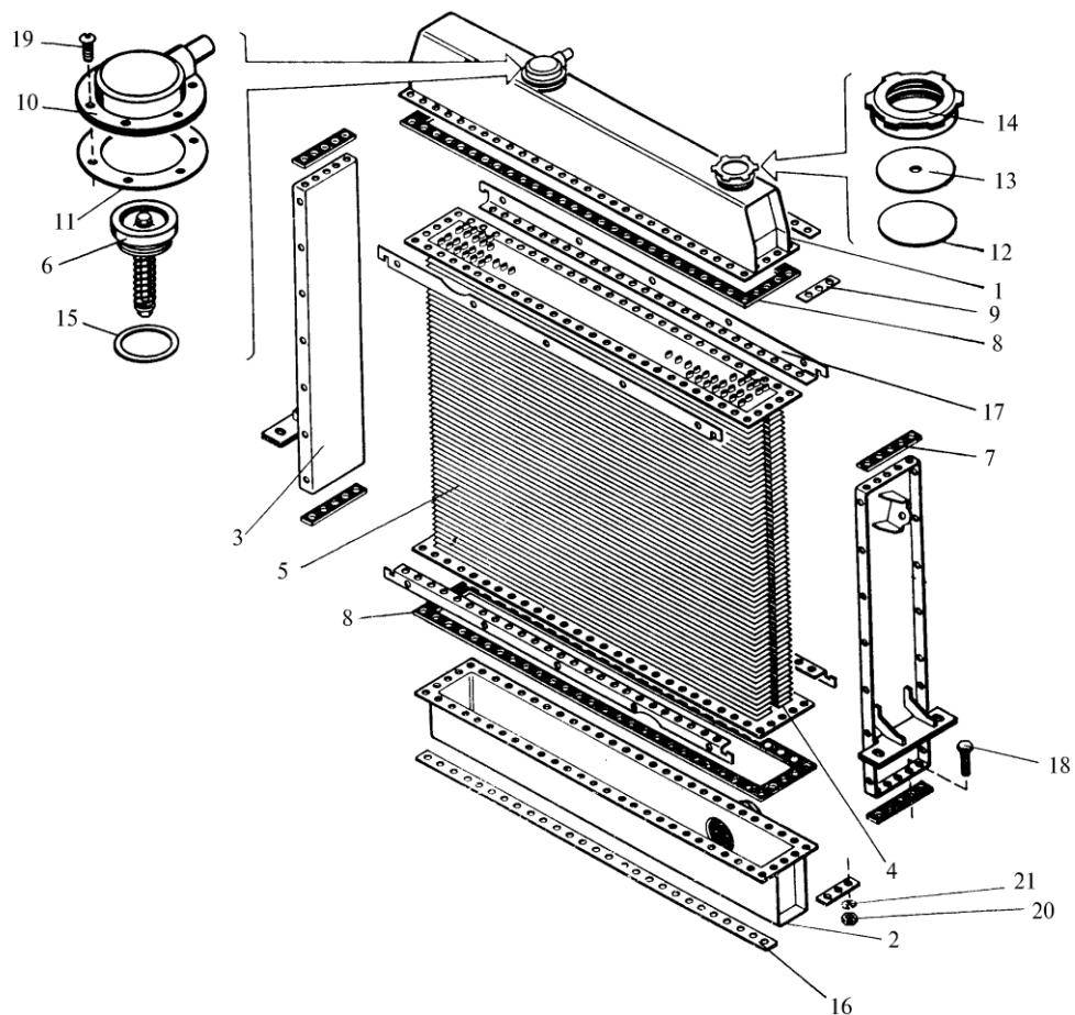
Рис. 9а. Радиатор водяной (К-703М-12)
