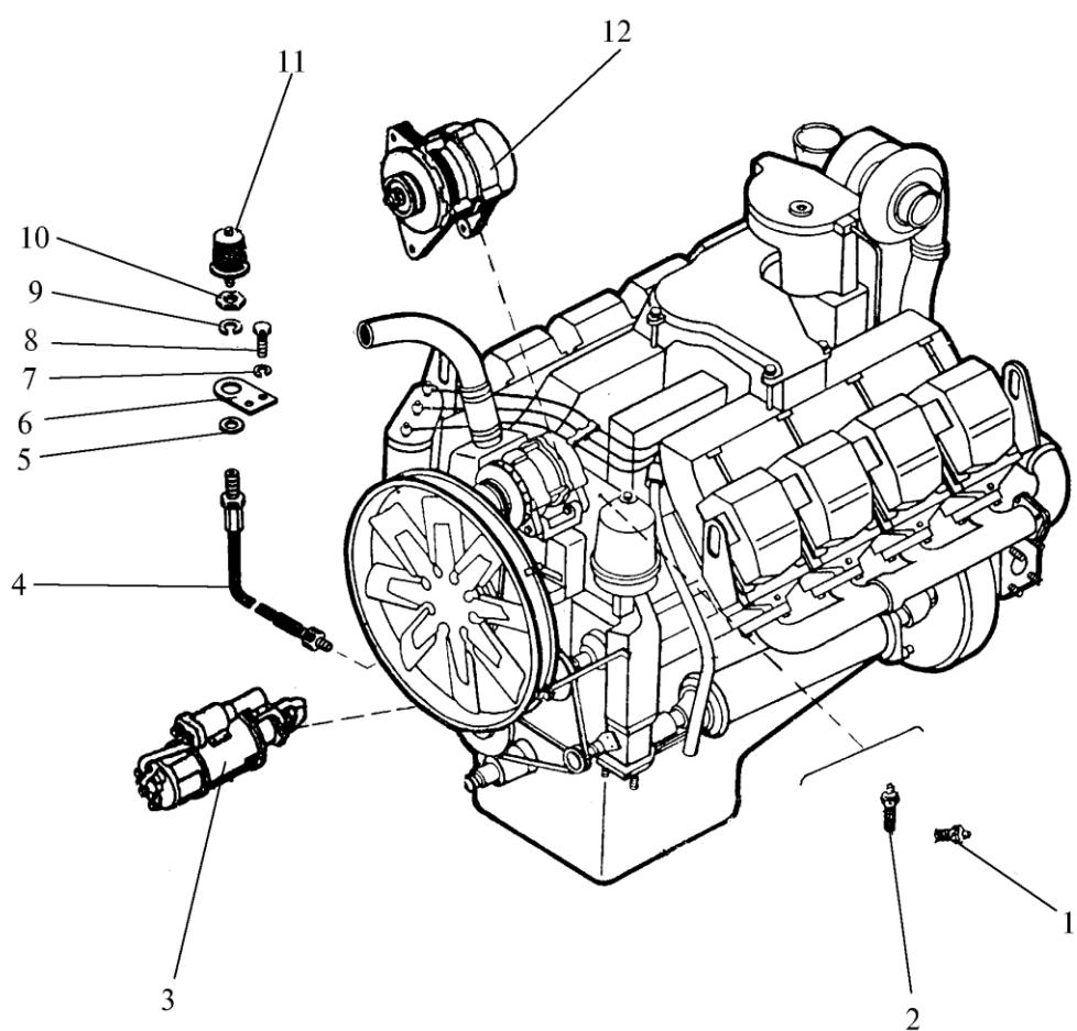
Рис. 71а. Электрооборудование двигателя (К-703М-12)
