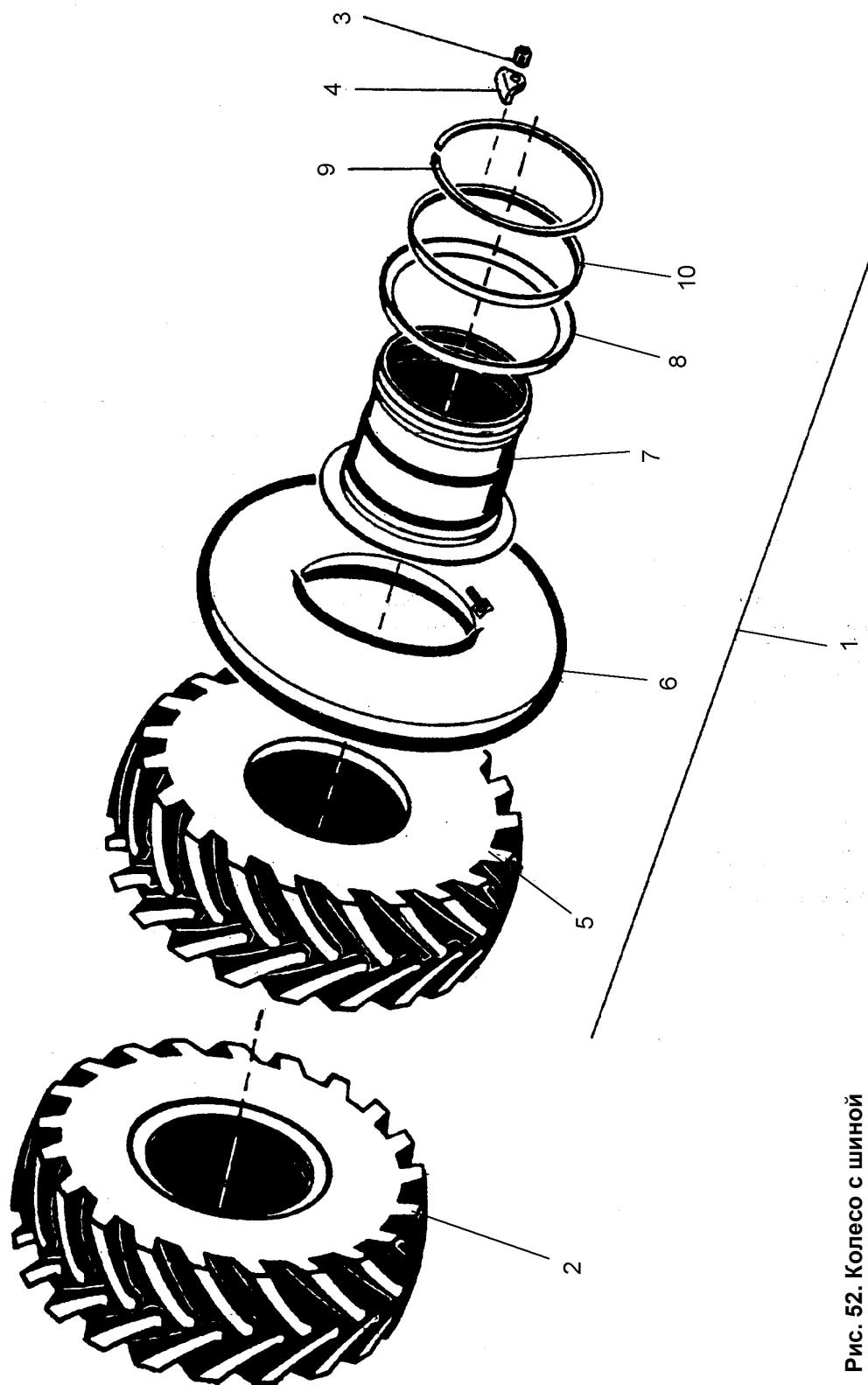
Рис. 52. Колесо с шиной
