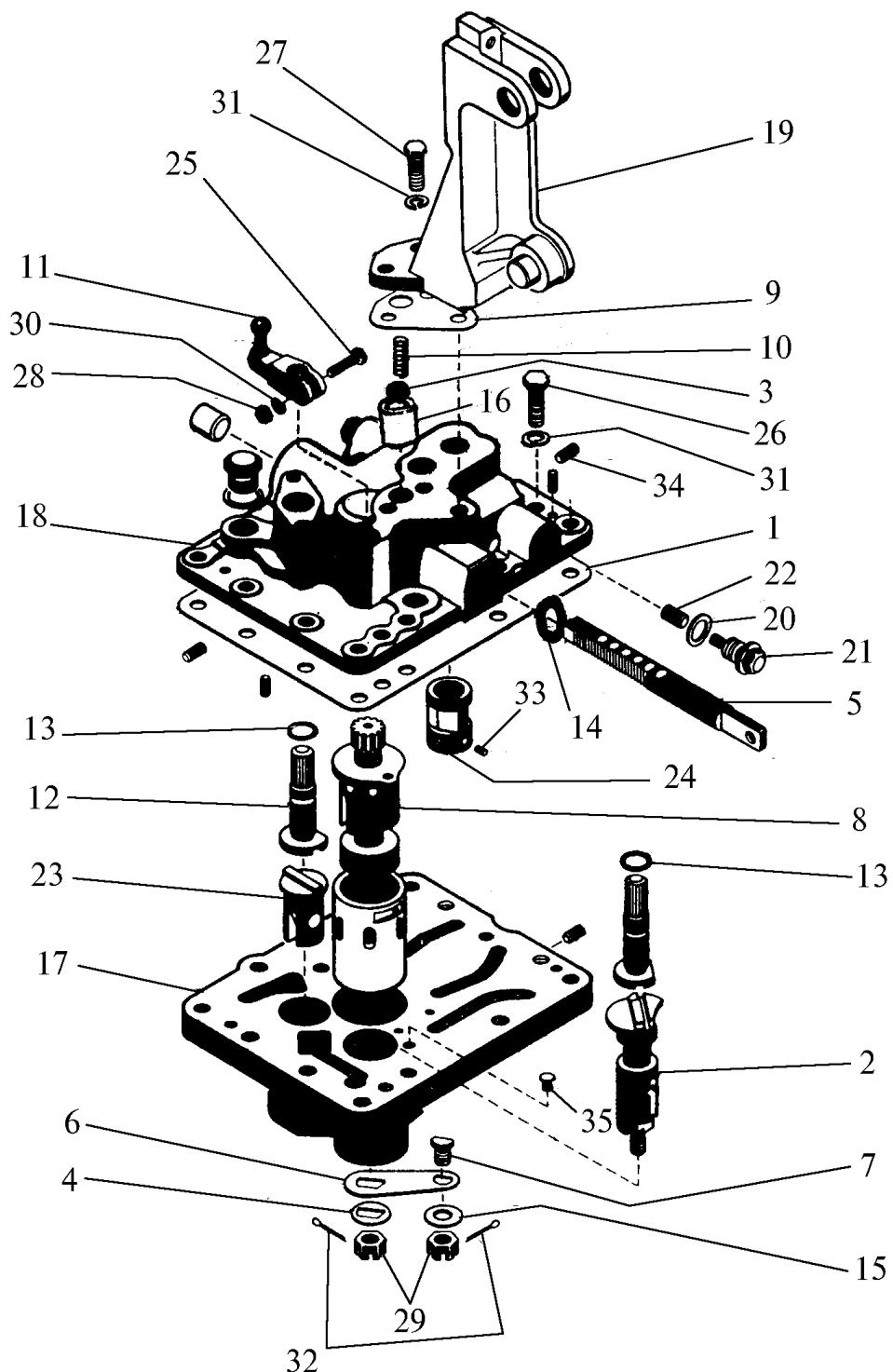
Рис. 30. Механизм переключения передач
