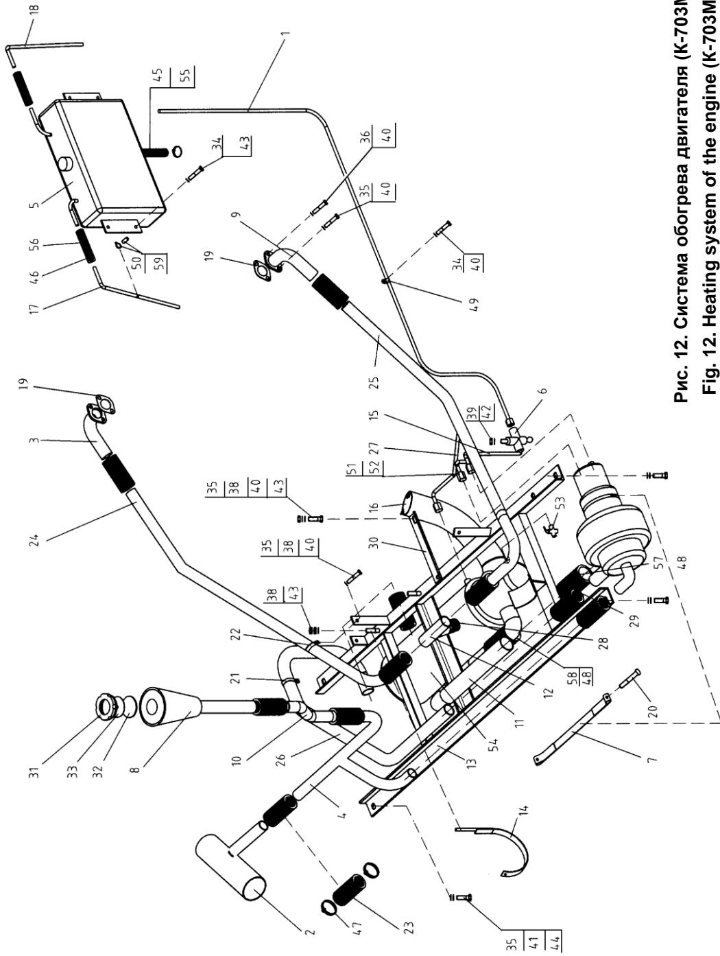
Рис. 12. Система обогрева двигателя (К-703МА-12)
