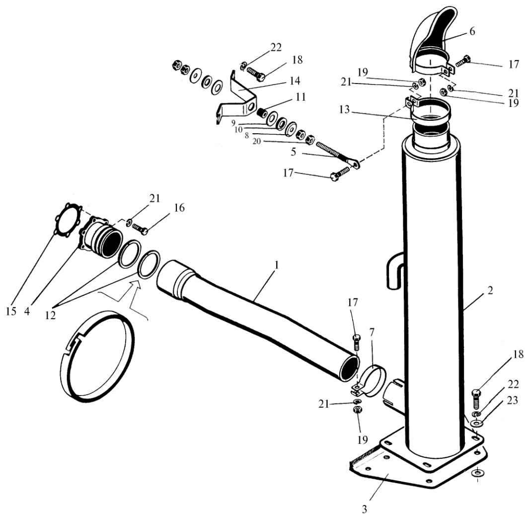
**Рис. 3. Система выпуска отработавших газов (К-703МА-12)**
