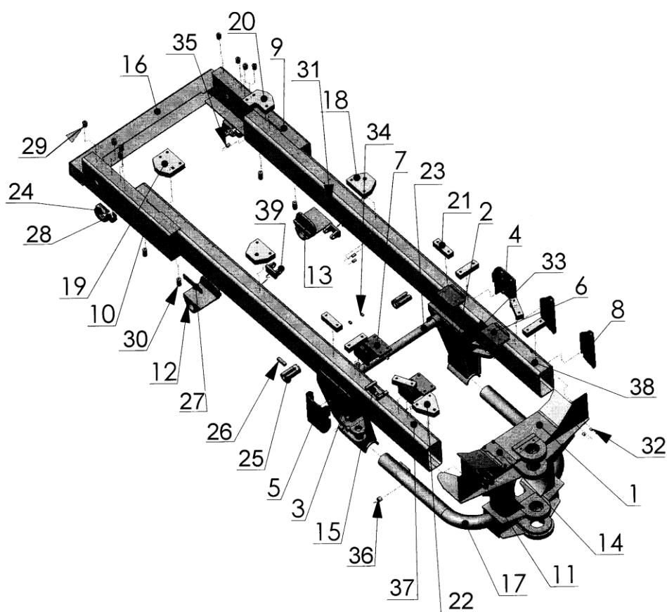
Рис. 39. Полурама подмоторная для двигателя ЯМЗ-238НД4
