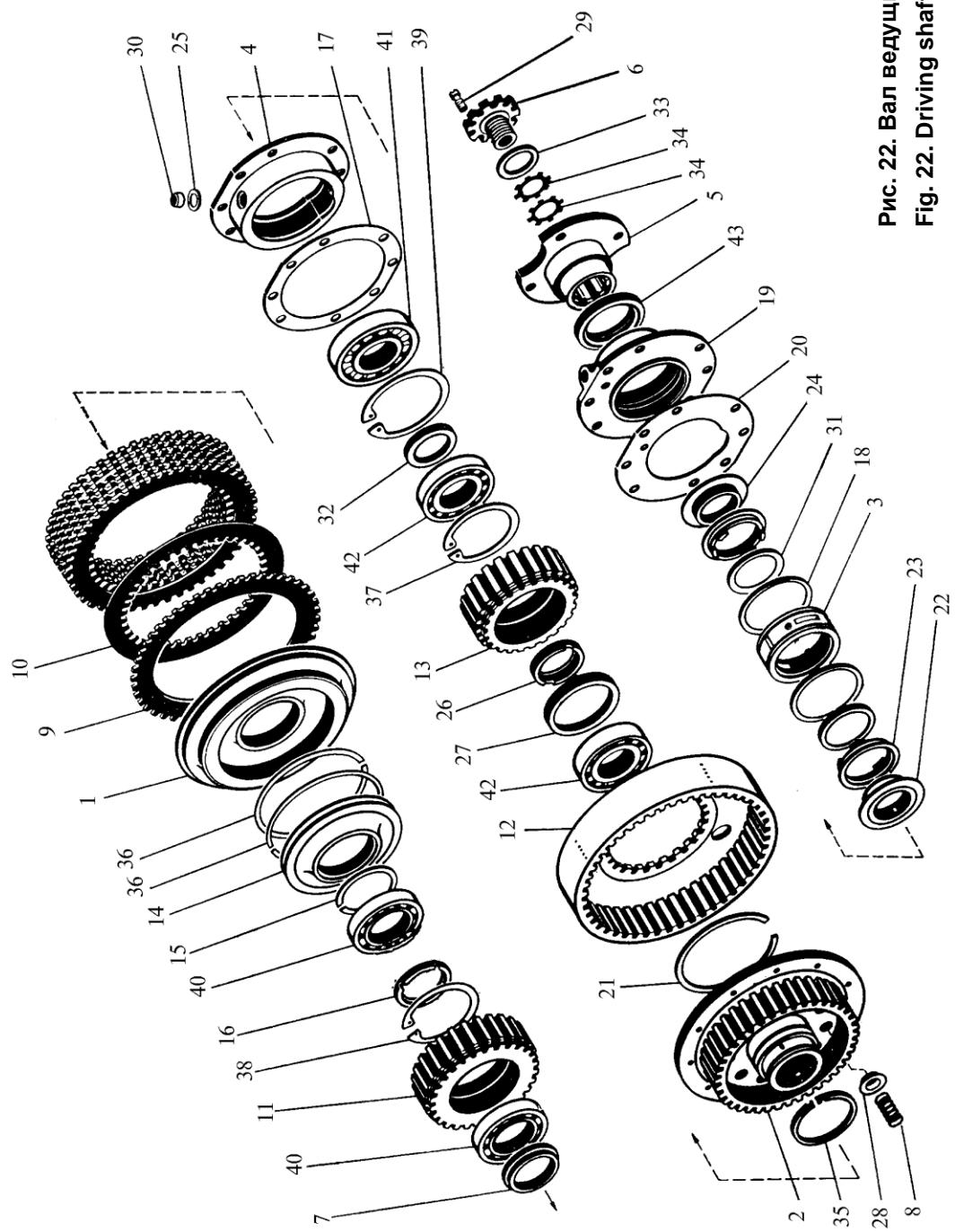
Рис. 22. Вал ведущий (I фрикцион)
