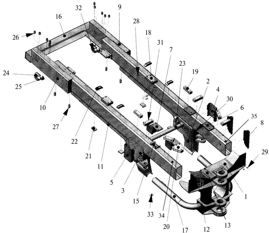
Рис. 39в. Полурама подмоторная для двигателя 8481.10
