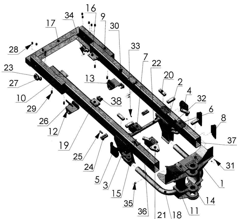
Рис. 39б. Полурама подмоторная для двигателя 8481.10
