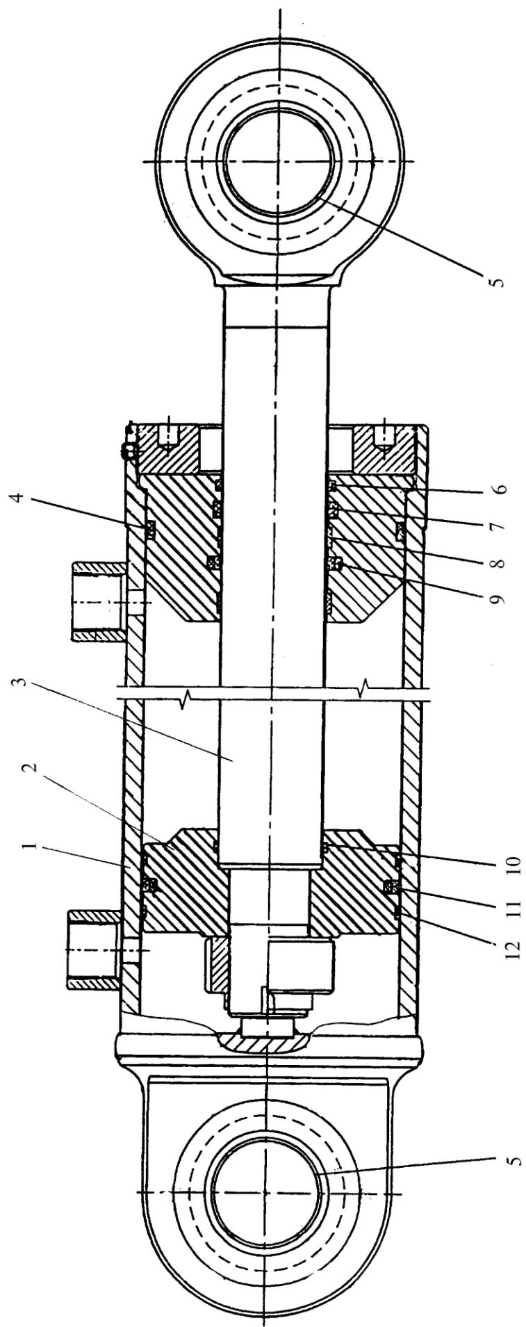
Рис. 50. Гидроцилиндр поворота (Данфосс)
