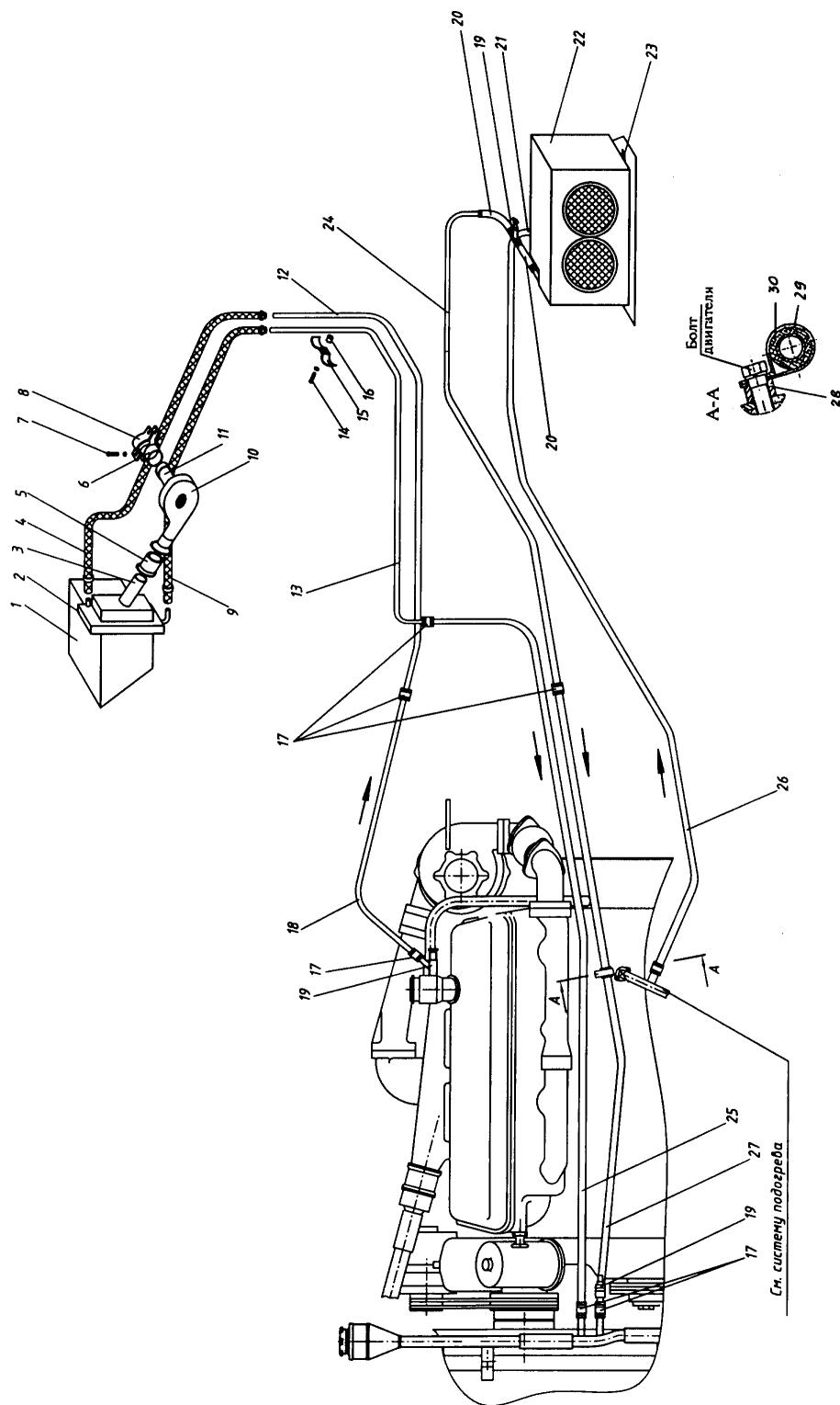
Рис. 70. Вентиляция и отопление кабины (К-703МА-12)
