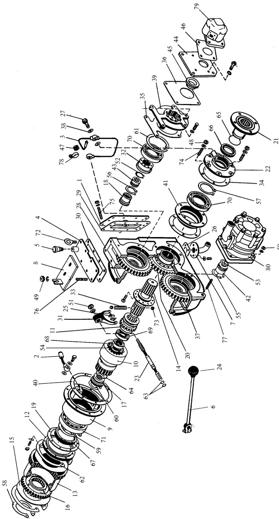
Рис. 16. Редуктор привода насосов (К-703МА-12 / К-703М-12)
